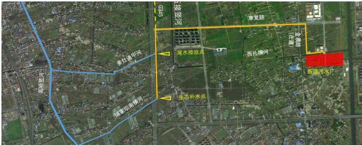
图 3.1.2-3 污水厂尾水管道方案图
